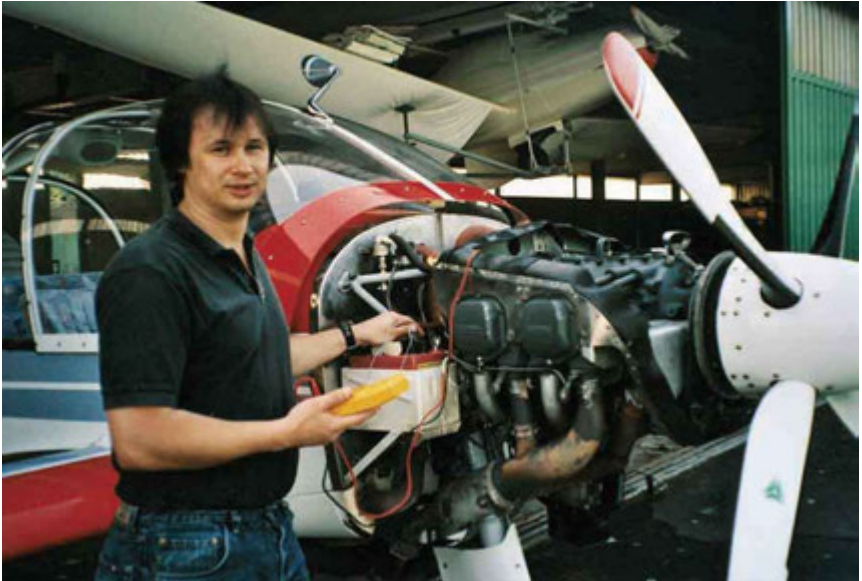
Eine wichtige Arbeit verrichtet Christoph Mutschler. Hier eine routinemäßige Motorkontrolle bei unserer Schleppmaschine, der Robin Remorqueur DR 400, mit dem Rufzeichen D-EHLR.
